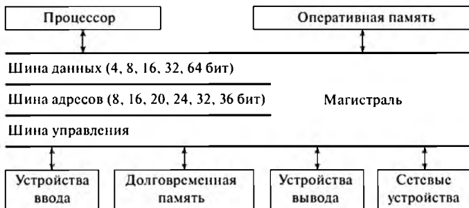
Рис. 3.21. Магистрально-модульное устройство компьютера
