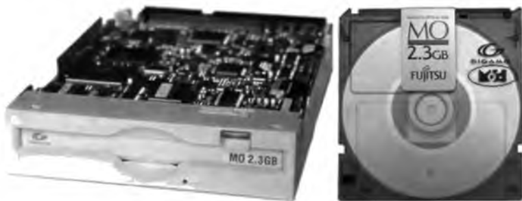
Рис. 4.17. Магнитооптический дисковод и диск
