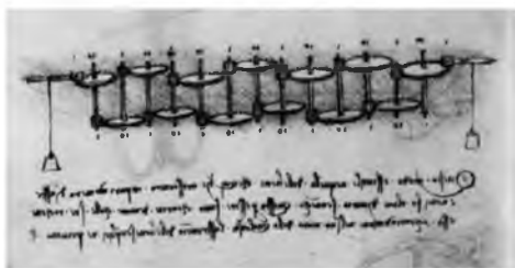
Рис. 3.3. Чертеж суммирующей машины Леонардо да Винчи
