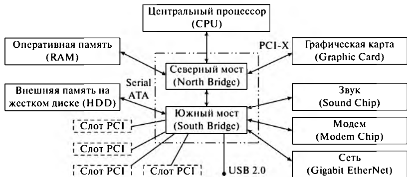
Рис. 4.3. Архитектура технологии 3GIO
