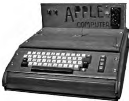
Рис. 3.18. Первый компьютер компании Apple (Apple-1)
