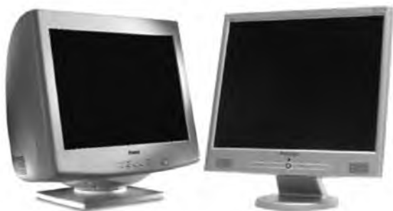
Рис. 4.23. ЭЛТ-монитор и ЖК-дисплей
