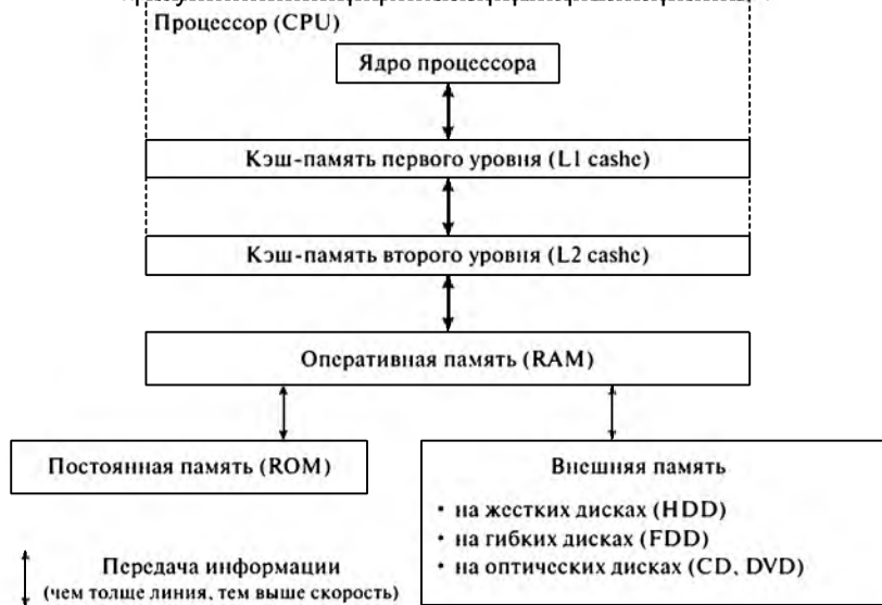
Рис. 4.9. Структура памяти современных компьютеров
