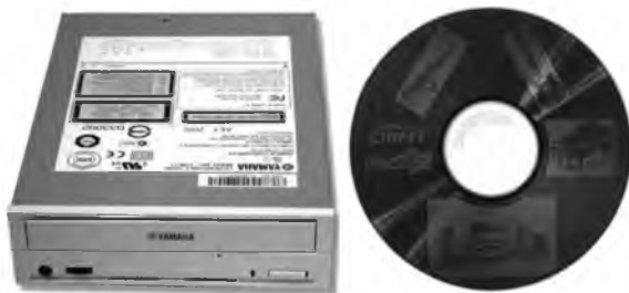
Рис. 4.18. Привод CD-ROM и компакт-диск
