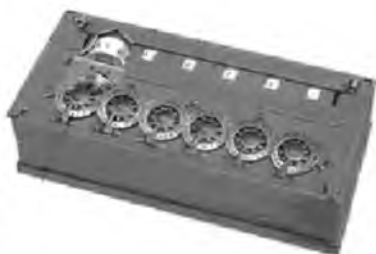
Рис. 3.5. Счетная машина Паскаля («Паскалина»)
