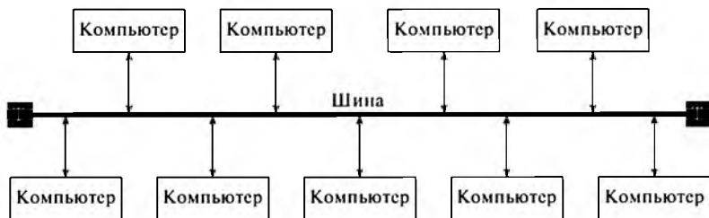
Рис. 14.1. Топология сети «шина»
