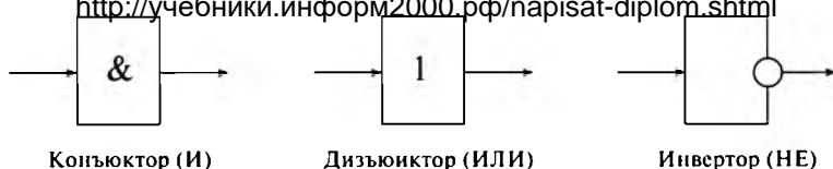
Рис. 1.2. Обозначения базовых логических элементов
